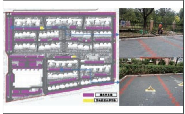
图10 下凹式绿地建设布局图
